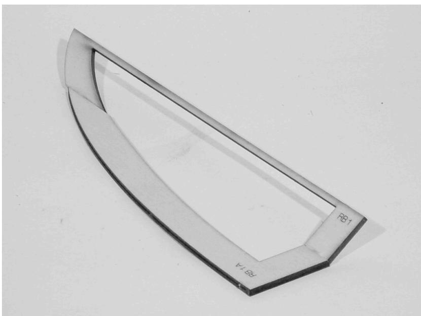
Das Grundgerüst eines der beiden Flügelrandbogens, bestehend aus Teil (RB 1) und (RB 1A)
