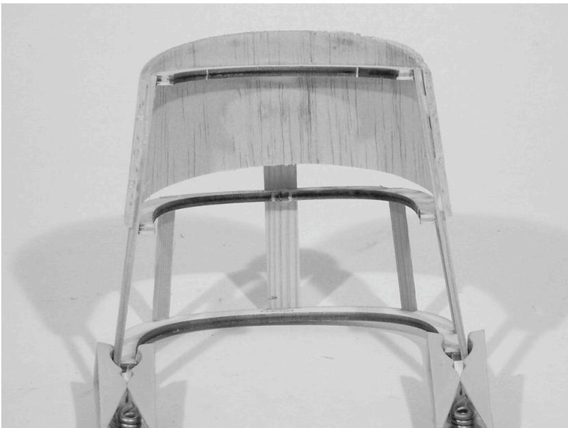
Die Motorverkleidung von oben gesehen. Deutlich zu sehen, dass der Balsastreifen schräg über (RS 1) geklebt wird.
