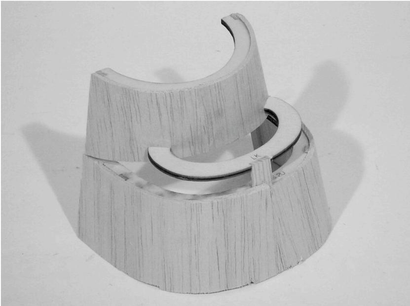
Der Bereich zwischen Rumpfspant (RS 2) und dem Lufteinlassteil (LK) wird mit Balsafüllstücken aufgefüllt und danach schön sauber rund verschliffen.
