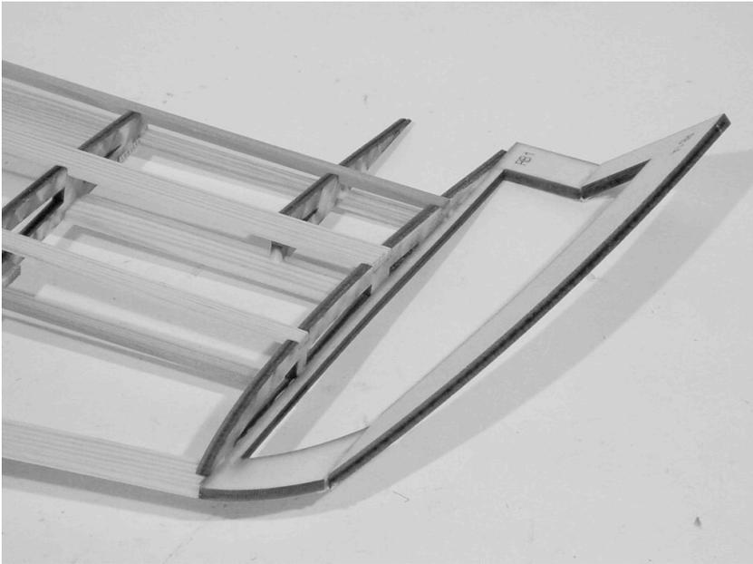
Das vorgefertigte Randbogenteil stumpf auf die äusserste Flügelrippe aufkleben.
