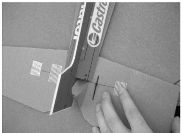
11. Mit UHU-POR die Rumpfunterseite und die unteren Rumpfstärkungen ankleben. **Darauf achten, dass diese ebenfalls im rechten Winkel und gerade wie auf der Oberseite angeklebt werden.**
