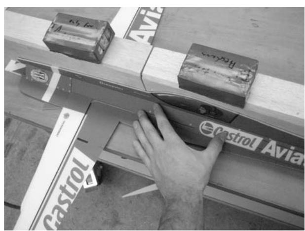
10. Mit UHU-POR in das Höhenruder ein doppeltes Ruderhorn (17) einkleben und das Gegenlager (18) montieren. An das Gegenlager etwas UHU-POR geben und in die Höhenruderrflosse einschieben. Das Höhenruder mit Glasfaserklebeband anschlagen.
