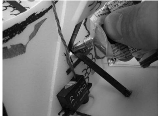
27. Jetzt können die Radachsen (35) mit der Radachsenbefestigung verklebt werden. Hierzu geben Sie einen kleinen Tropfen dickflüssigen Sekundenkleber in die Radachsenbefestigung und schieben dann die Radachse in die Radachsbeifigung ein. **Darauf achten, dass die Radachse parallel zum Boden verläuft.**
