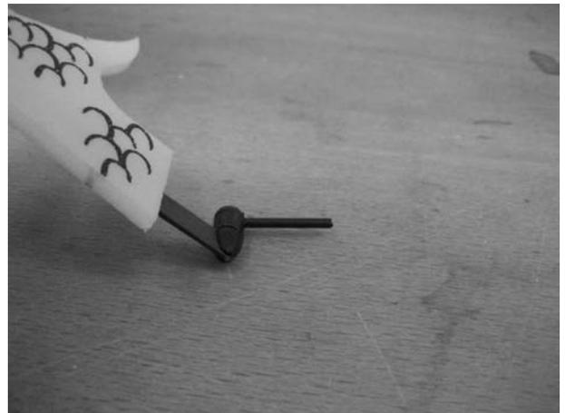
28. Kleben Sie die Radverkleidungsbefestigungen (36) mit UHU-POR an die Radverkleidungen (37). **Auf rechte und linke Teile achten.**
