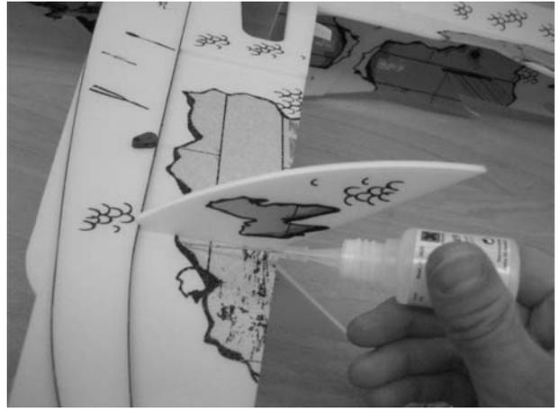
18. Die Querruder konnen nun montiert werden. Die Montage der Ruderhorner ist dieselbe wie beim Hohenruder.
