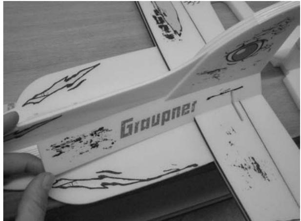
13. Mit UHU-POR in das Höhenruder ein doppeltes Ruderhorn (25) einkleben und das Gegenlager (26) montieren. An das Gegenlager etwas UHU-POR geben und in die Höhenruderflosse einschieben. Das Höhenruder mit Glasfaserklebeband anschlagen.
