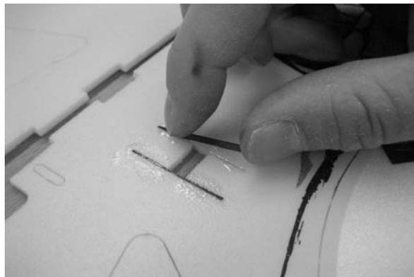
9. Kleben Sie mit UHU POR die oberen (22) und unteren (20 und 21) Rumpfverstärkungen auf das Rumpfoberteil (15) und das Rumpfunterteil(23).
