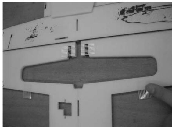
8. Vom Rest der Tragflächenverstärkung (11) längen Sie vier Mal 30 mm ab und kleben diese mit UHU-POR an die beiden unteren Rumpfhälftenverstärkungen (20 und 21) bündig zur Fahrwerksdurchführung. Die restlichen zwei Abschnitte werden in die untere Rumpfhälfte, in die dafür vorgesehenen Aussparungen geklebt.
