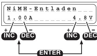
Questo programma è utile per es. per determinare la capacità residua oppure per la scarica dell'accumulatore di una trasmittente, di una ricevente o di alimentazione di un motore. Con questo programma viene effettuata la scarica con una corrente di scarica impostata (0.10 ... 5.0 A, a sinistra sul display) fino alla tensione finale di scarica (0.1 ... 16.8 V, a destra sul display).
