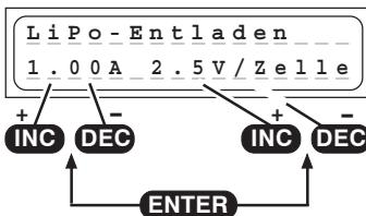
Dieses Programm dient z.B. zum Feststellen der Restkapazität eines noch nicht leeren Lithiumakkus.
