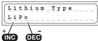
C'est le programme de réglage le plus important pour les accus au Lithium. Le type d'accu sera déterminé dans cette sélection. Celui-ci sera soigneusement réglé et vérifié, car le chargeur travaille sur tous les autres paramètres de charge pour ces réglages. Le réglage des types d'accus (LiPo, Lilo ou LiFe) influence la tension de coupure. Si un accu au Lithium n'est rechargé qu'au 2/3 de sa capacité, c'est qu'un mauvais type d'accu a été réglé.
