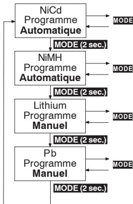
Les possibilités de charge et de décharge de l'ULTRAMAT 16 sont clairement et logiquement réparties dans les quatre groupes de programmes. Un groupe de programmes propre à chacun des différents types d'accu NiCd, NiMH, LiPo/LiPo/LiFe et **Pb (Plomb)** est à disposition. Un autre groupe de programmes permet des possibilités de réglage Programme individuelles du chargeur.
