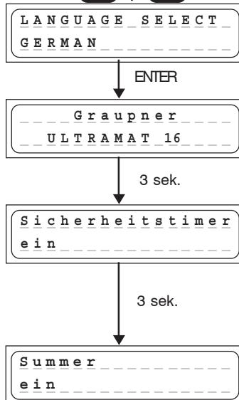
Drücken Sie die Tasten INC und DEC gleichzeitig, während Sie das Gerät mit der Eingangsspannung versorgen, um in die Sprachauswahl zu gelangen. Drücken Sie die Tasten INC oder DEC um die gewünschte Sprache ENGLISH, GERMAN (Deutsch) oder FRENCH auszuwählen. Verlassen Sie die Sprachauswahl mit indem Sie die Taste ENTER drücken.
