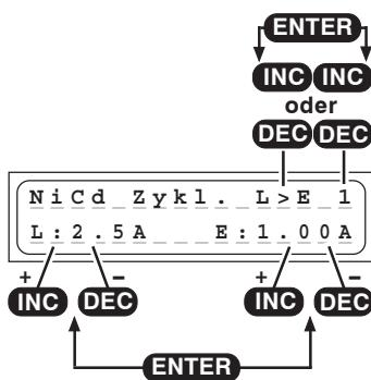
Dieses Programm dient zur Optimierung von Kapazität und Formierung einer Batterie.
