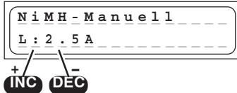
Bei diesem Programm wird der Akku mit dem eingestellten Ladestrom aufgeladen.
