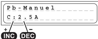
Avec ce programme, le courant de charge maximal admissible pour l'accu à charger sera réglé avec les touches INC/DEC, avant sa connexion sur le chargeur. Ce réglage place seulement la limite supérieure, car le chargeur doit sonder l'accu.
