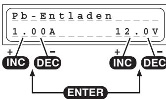
Dieses Programm dient z.B. zum Ermitteln der Restkapazität eines Antriebsakkus.
