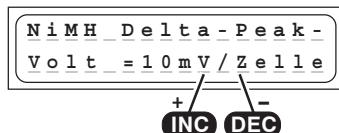
La tensione di riferimento (in mV per cella!) dello spegnimento automatico per gli accumulatori NiMH può essere impostata. Gli accumulatori NiMH tuttavia hanno una caduta di tensione inferiore agli accumulatori NiCd. Si sono rivelati accettabili valori di impostazione della tensione di 5 ... 25 mV/cella. Tensioni superiori provocano rapidamente una sovraccarica dell'accumulatore, tensioni inferiori provocano spesso un'interruzione anticipata.
