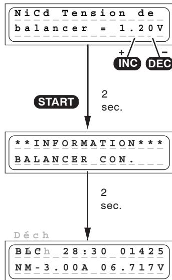
Ce programme sert pour la coordination de la tension des différents éléments pour les packs d'accus de 2-6 éléments. Placer la tension de fin de décharge du Balance 1.20...1.30 V avec la touche INC ou DEC.
