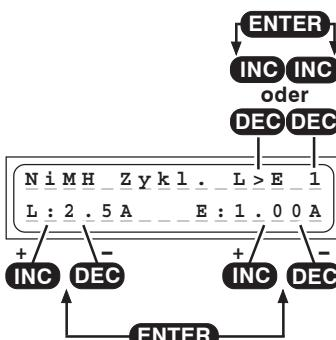
Mit der INC oder DEC Taste stellen Sie oben rechts ein, ob das Formierungsprogramm mit dem Laden oder Entladen beginnen soll. Anschließend stellen Sie die Zyklenzahl von 1-5 ein (bei z.B. 3 Zyklen wird der Akku dreimal geladen und entladen). Das Programm entlädt den Akku mit dem rechts im Display eingestellten Entladestrom (0,10...5,00A) um ihn anschließend mit dem links im Display eingestellten Ladestrom (0,1..8,0A) wieder aufzuladen.
