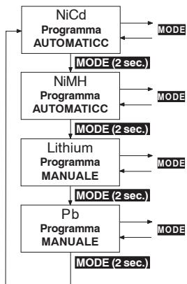
Le possibilità di carica e scarica dell'ULTRAMAT 16 sono suddivise in modo chiaro e logico in quattro gruppi di programmi. Per i diversi tipi di accumulatori : Nichel-Cadmio, Nichel-Metal Idrato, Ioni di litio / Polimeri di litio / LiFePO<sub>4</sub> (LiFe) e Piombo c'è a disposizione un proprio gruppo di programmi.
