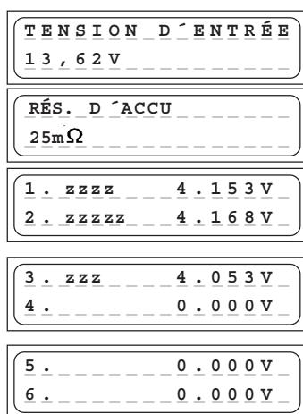
La tension d'entrée actuelle et la résistance interne de l'accu (seulement dans le mode manuel NiCd et NiMH) pourront être appelées à tout moment par la pression **simultanée** des touches INC et DEC. Par la pression des touches INC ou DEC, l'affichage s'échange pour la résistance interne, les tensions séparées d'éléments ou pour la tension d'entrée.
