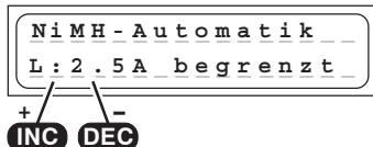
In questo programma il caricabatterie riconosce il tipo di accumulatore collegato e adegua la corrente di carica adatta, in modo da evitare una sovraccarica all' accumulatore.
