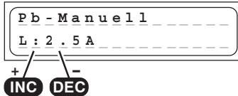
Con questo programma si può impostare, prima di collegare l'accumulatore, con i tasti INC / DEC, la massima corrente di carica ammessa (corrente di carica massima).
