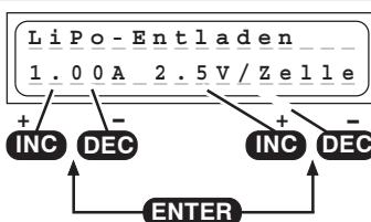
Questo programma serve per es. per determinare la capacità residua di un accumulatore non ancora scarico. Con questo programma la scarica viene effettuata con la corrente di scarica impostata (0,10...5,0 A, a sinistra sul display) fino al raggiungimento della tensione finale di scarica impostata (2,5...3,7 V per cella, a destra sul display). La tensione finale di scarica di 2,5 V per cella non può essere superata, altrimenti l'accumulatore può danneggiarsi.
