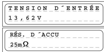
Le tension d'entrée et la résistance actuelles de l'accu (seulement dans le mode manuel NiCd et NiMH) pourront être appelées à tout moment en pressant **simultanément** les touches INC et DEC. Par la pression des touches INC ou DEC, l'affichage s'échange pour la résistance interne, les tensions séparées d'éléments ou pour la tension d'entrée.
