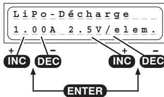
Ce programme sert par ex. pour déterminer la capacité restante d'un accu au Lithium non entièrement vide.
