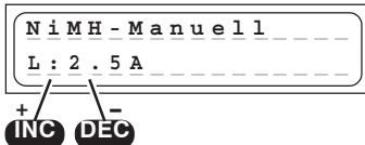
Con questo programma l'accumulatore viene caricato con la corrente di carica impostata. La corrente di carica massima può essere impostata con i tasti INC / DEC da 0.1 A a 8.0 A **prima** di collegare l'accumulatore.
