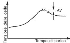
Lo spegnimento automatico del processo di carica (riconoscimento di accumulatore completamente carico) funziona secondo il principio del delta peak, già provato milioni di volte e noto anche come delta-U o delta-V. In questo procedimento viene valutata la tensione massima della curva di carica, che indica con molta precisione la massima carica immagazzinata.
