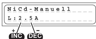
Con questo programma potete caricare il vostro accumulatore con la corrente impostata. La corrente massima può essere impostata prima di collegare l'accumulatore con i tasti INC / DEC da 0.1 a 8.0 A. Il processo di carica termina in accordo con i valori impostati per la tensione di spegnimento del delta peak.
