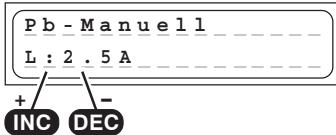
Bei diesem Programm wird vor dem Anstecken des zu ladenden Akkus mit den INC / DEC-Tasten der für den Akku maximal zulässige Ladestrom (maximaler Ladestrom) eingestellt.
