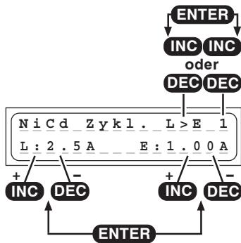
Questo programma serve per ottimizzare la capacità e la formattazione di un accumulatore. In alto a destra sul display impostate, con i tasti INC / DEC se il programma di formattazione deve iniziare con la carica o la scarica. Quindi impostate il numero di cicli da 1 a 5 (per es. imponendo 3 cicli, l'accumulatore viene caricato e scaricato tre volte).
