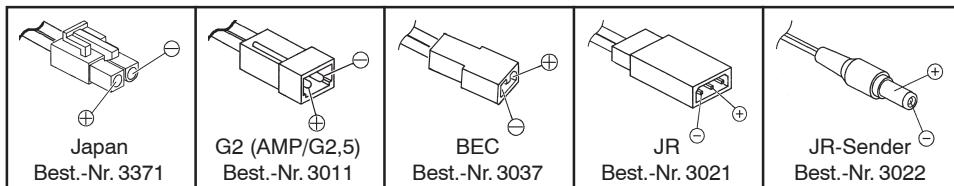
Verwenden Sie nur Original-Ladekabel mit ausreichendem Drahtquerschnitt.
