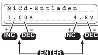
Dieses Programm dient z.B. zur Feststellung der Restkapazität oder zur definierten Entladung eines Sender-, Empfänger oder Antriebsakkus
