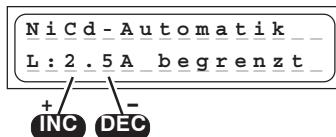
In questo programma il caricabatterie riconosce il tipo di accumulatore collegato e adegua la corrente di carica corretta, in modo da evitare un sovraccarico dell'accumulatore. La corrente di carica massima può essere impostata con i tasti INC / DEC prima di collegare l'accumulatore da 0.1 a 8.0 A senza limitazioni. Il processo di carica termina in accordo con i valori impostati per la tensione di spegnimento del delta peak.
