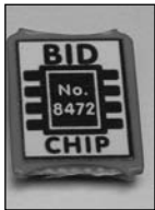
BID-Chip ohne Kabel, zur Ausstattung weiterer Akkus No. 8472
